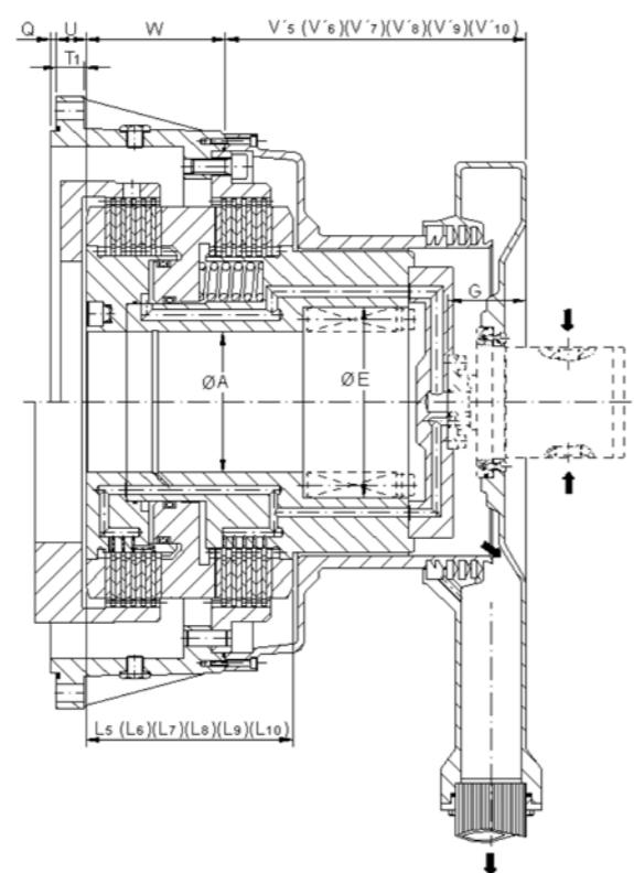
Fijación por anillo de presión por el lado del embrague en un extremo de eje y entrada de aceite por el moyú.
