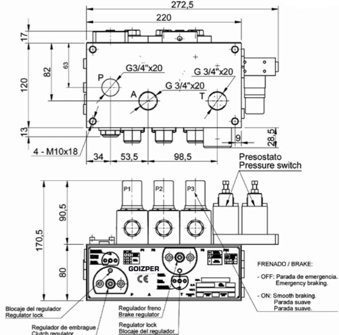
La válvula de control con regulación de embragado y frenado (3EV) es utilizada para controlar freno-embragues hidráulicos.
