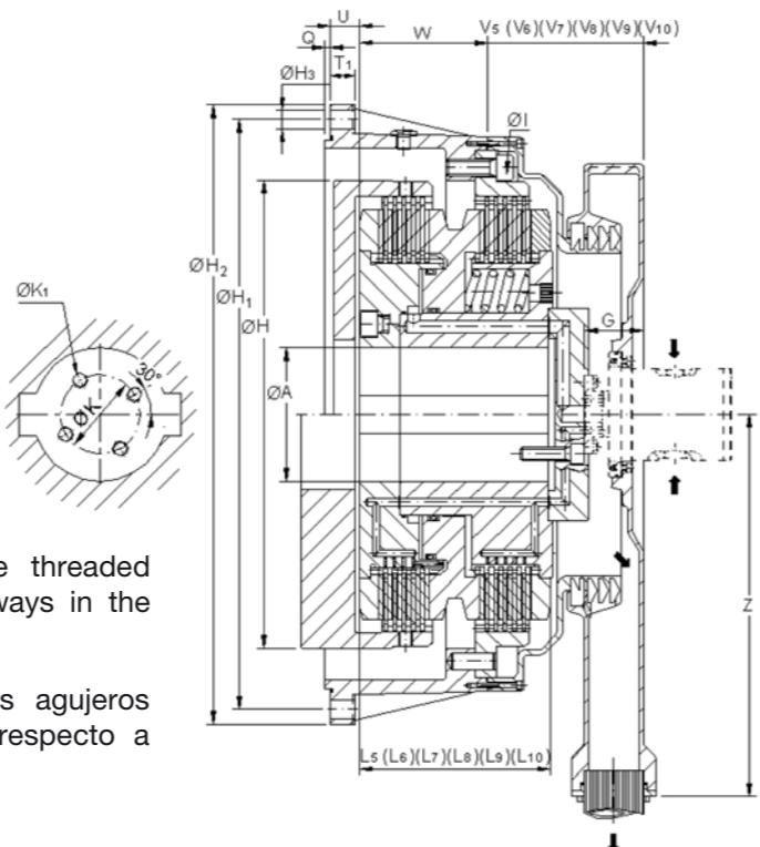
Fijación al eje por chavetas en un extremo de eje y entrada de aceite por el moyú.
