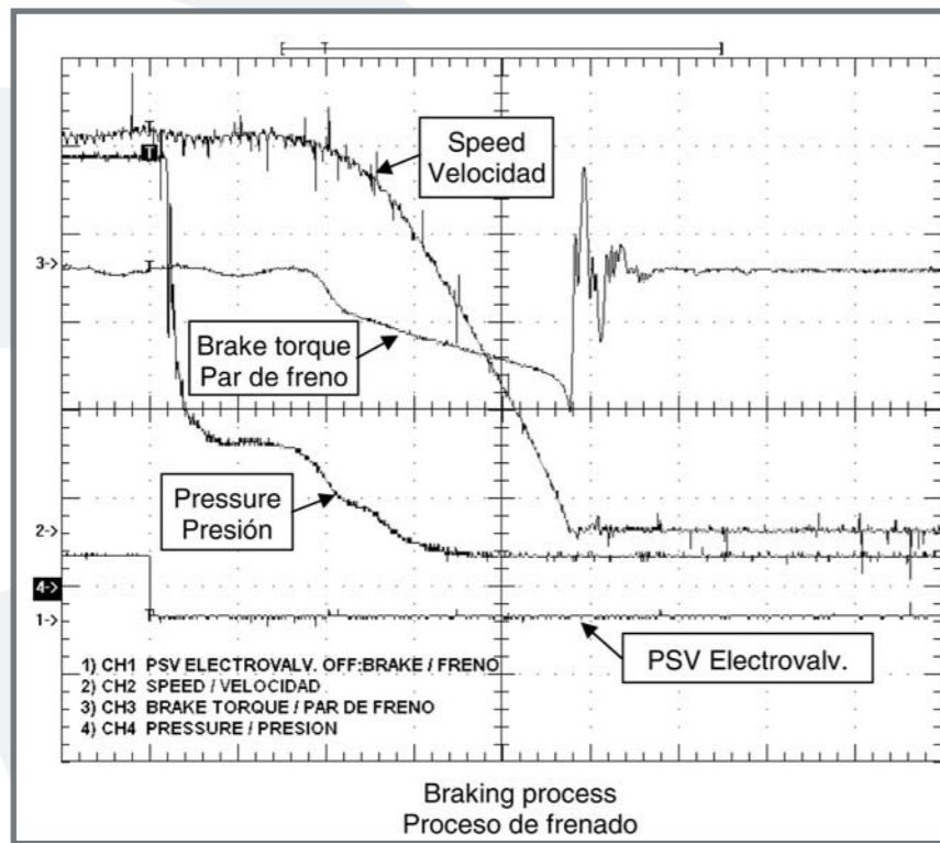
A continuación se pueden ver dos ejemplos de mediciones reales realizadas con osciloscopio; el primero muestra el proceso de embragado mientras que el segundo es sobre el proceso de frenado de un freno-embague hidráulico:
